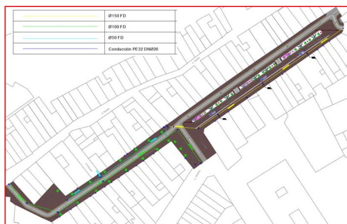
Ilustración 3. Planta proyectada de abastecimiento y riego.
