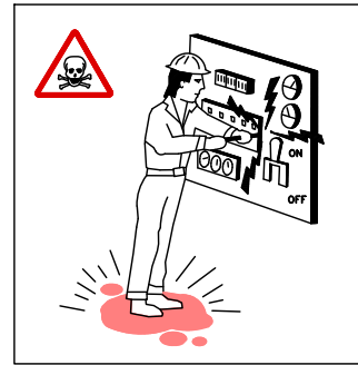
REPARACION DE EQUIPOS BAJO TENSION
